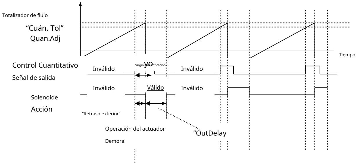
Cuando el parámetro "OutDelay" =0, cuando el valor de salida cuantitativa alcanza el valor de "Quan.Tol" – "Quan.Adj", la función de salida cuantitativa "Ctrl" comienza a funcionar y siempre continúa. Si desea detenerlo, elimínelo manualmente.
